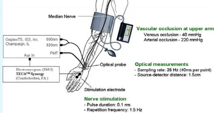
Fig. 8 Picture of actual experimental setup
